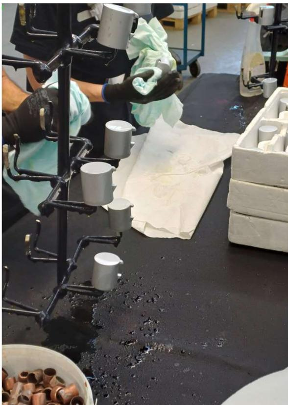
Presso la ditta A è stato effettuato un campione di studio di **acque di sgocciolamento** dai pezzi dopo **l'ultimo lavaggio** per verificare il contenuto residuo di cromo esavalente, in quanto era evidente il colore giallo dell'acqua residua sui pezzi a fine trattamento.
