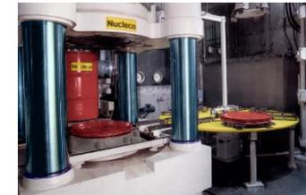
Impianto di supercompattazione
